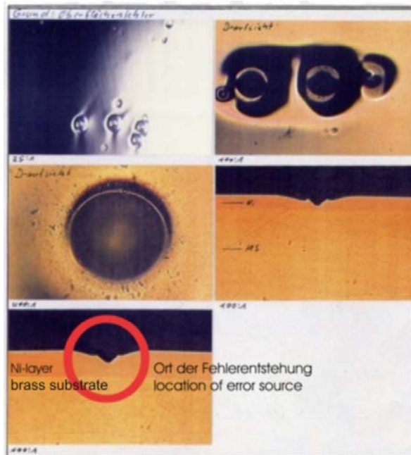
Afbeelding 2: Details van de analyses van de structurele fouten in de galvanische vernikkeling.
