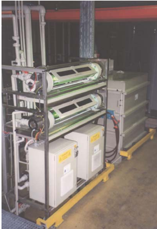
Afbeelding 1: Enviolet® - UV – installatie voor plateerbathbehandeling
