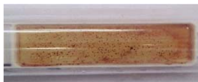
Foto 3: KVE (Kolonie vormende eenheden units) van 105 - 106 /mL, werden teruggevonden in DI water bij een Europees producent van PCB (printing circuit boards) die hoge kwaliteitscriteria aanhoudt. Het water is zichtbaar klaar en zuiver en ook de geleidbaarheid is niet alarmerend, niettegenstaande de biologische kwaliteit ver boven de grens van toelaatbaarheid ligt. Gevolg: slechte afgewerkte stukken, m.a.w. productieverlies.
