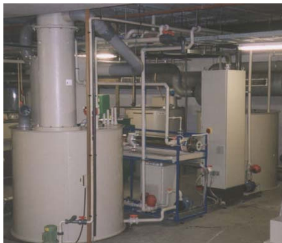
Foto 2: Zicht op de installatie bij Ramaer: Opslagtank met directe koeler en druppelvanger, UV reactor en verhitter, elektriciteitskast en procescontrole, opslagtank voor concentraat (van links naar rechts)
